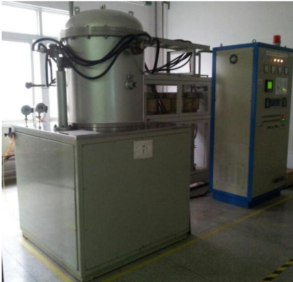
立式真空炉外观 (实景拍摄于 2013 年)
